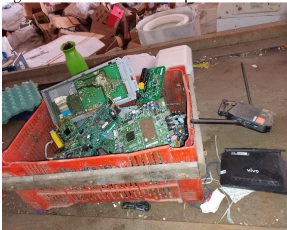
Figura 4 – PCIs removidas a partir de REEE
