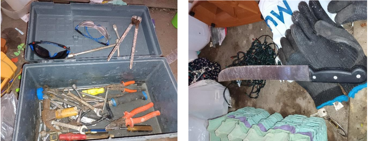
Figura 5 – Ferramentas rudimentares utilizadas no processo de retirada das PCIs dos EEE
