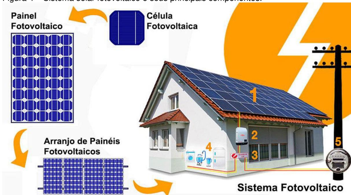
Fonte: Portal Solar (2016a). Legenda: 1. O Painel Fotovoltaico produz energia elétrica em corrente contínua; 2. O inversor de frequência transforma esta energia em corrente alternada; 3. A energia elétrica produzida pelas células fotovoltaicas nos painéis é transformada pelo inversor e conduzida ao quadro de distribuição; 4. Utilização da energia fotovoltaica pelos utensílios; 5. Relógio de luz bidirecional para contabilização da energia consumida da rede e da gerada pelos painéis fotovoltaicos.
