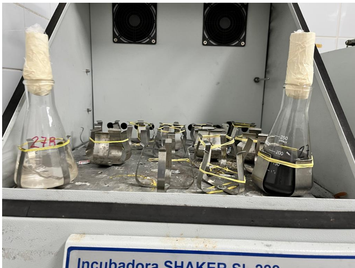
Figura 9 Ensaio de lixiviação da célula fotovoltaica na Incubadora shaker.
