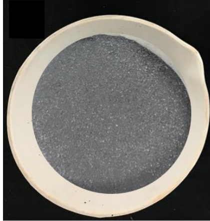
Figura 7 Célula fotovoltaica cominuída
