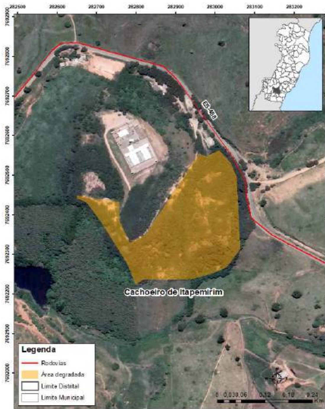
Figura 11-15 - Área degradada por disposição inadequada de resíduos sólidos no município.
